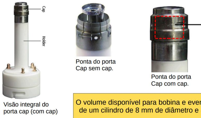
Figura 6. Espaço disponível no porta caps do PEEM para uma bobina.
